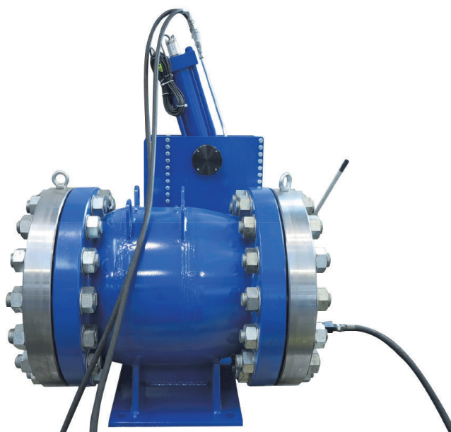
F600 PN100: test hydrauliczny 150 barów
