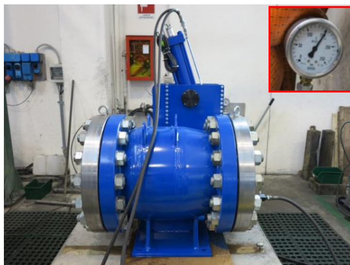
F600 PN100 : PRÓBY CIŚNIENIOWE (CIŚNIENIE TESTOWE = 150 BAR)
