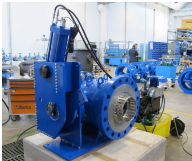
F600 PN100 : PRÓBY CIŚNIENIOWE (CIŚNIENIE TESTOWE = 150 BAR)
