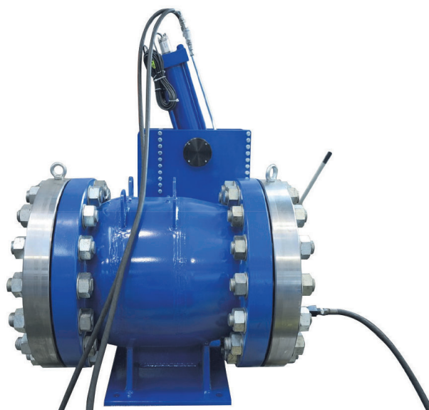
COLLAUDO IDRAULICO PER VALVOLE F600 PN100 (TEST IN PRESSIONE = 150 BAR)
