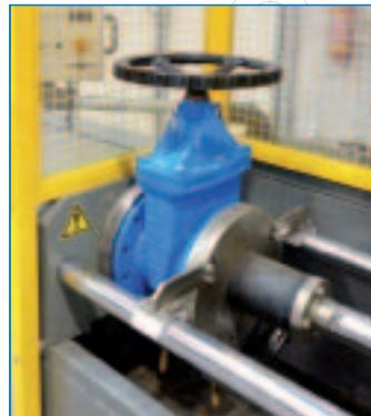
Ogni singolo prodotto a marchio T.i.S. viene testato con l'utilizzo dei più moderni banchi di prova.
